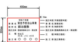
板の材質は、アルミ軽合金を原則とし、寸法及び記載事項は図のとおりとする。
